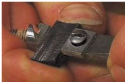
lâmina que desliza na cavidade do corpo da broca
